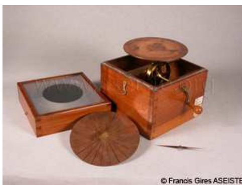
Fig. 3. L'appareil d'Arago pour montrer le "magnétisme de rotation" (Lycée Guez de Balzac, Angoulême).
